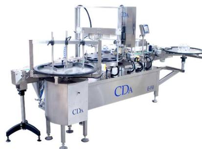
La E-Fill se distingue par sa modularité et son innovation technologique. Son système de remplissage s'adapte aux produits liquides et visqueux grâce à des options avancées : pompe péristaltique (changement rapide sans nettoyage), débitmètre massique ou électromagnétique et pompe à piston. Son interface tactile intuitive simplifie les réglages et mémorise 50 formats produits.
